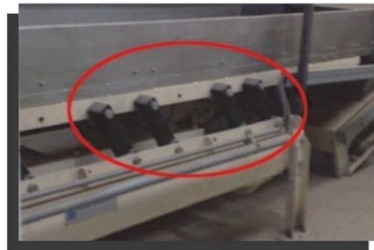
VIB TD-F в вибрационном конвейере
