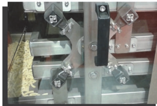
Мультисекционный конвейер с VIB TB
