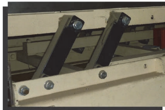
VIB TD-F в конвейере для производства табака
