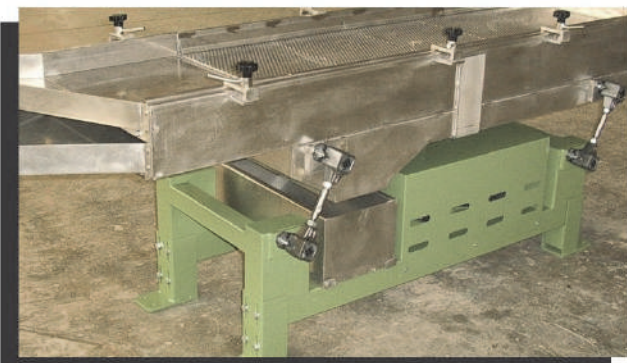
VIB BT-F в вибрационном конвейере для макаронных изделий
