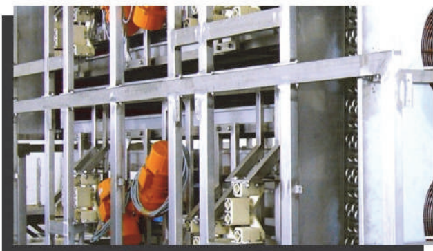
VIB DE-R опоры в машине для макаронных изделий
