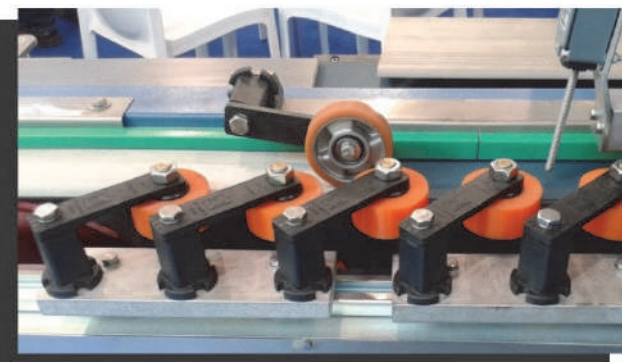
СIAO прижимные устройства на калибровочной машине
