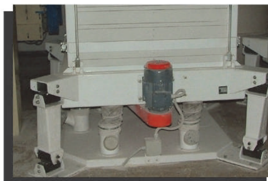
VIB CR-P в гираторном просеивателе
