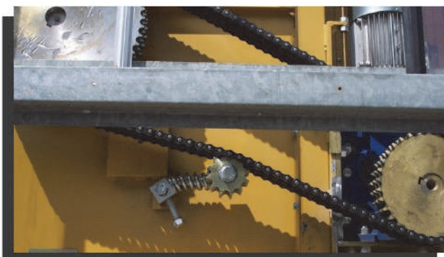
Натяжитель ARCO для цепного привода
