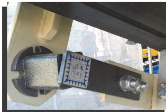
Ленточный скребок с применением рычага CRESA RE
