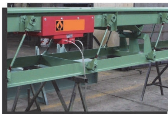
VIB BT-F в конвейере для щепы
