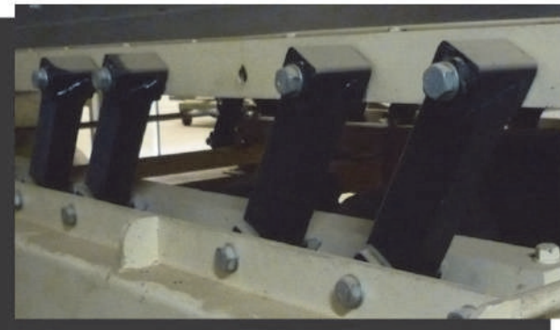
VIB TD-F в вибрационном конвейере
