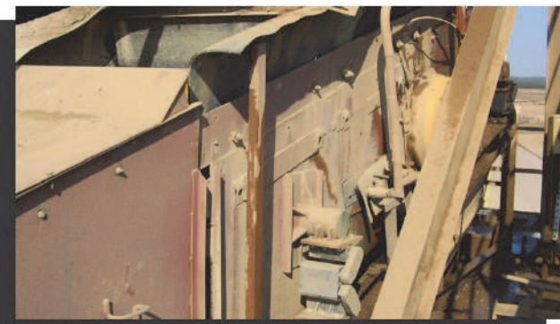
VIB DE-HR в дробильно-сортировочной линии
