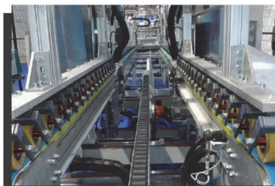
Натяжители CRESA в отрезной машине
